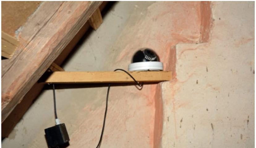
Webcam zur Überwachung von Hangplätzen. Bewährt haben sich fernsteuerbare Modelle mit geschütztem Objektiv und Infrarot-LEDs (Foto: Christian Dietz)
